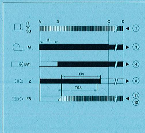
Fig. 8 Déroulement du programme du coffret de contrôle de combustion numérique pour brûleur fioul
